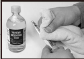
研磨の後、『"EX" 塗料共通うすめ液』をウエスなどに染み込ませ、表面の削りカスや水分、油分、塩分等をしっかりと除去して下さい。アイの部分も必ず行なって下さい。
