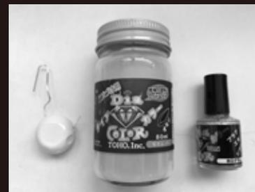
下地塗装が完了したら、同じ要領でカラー塗装を行って下さい（カラー塗装は2～3回程度のドブ漬けで色付けが可能です）。また、カラーが豊富なマニキュアタイプの『ダイアカラー』も使用しお好きなカラーに仕上げして下さい。
