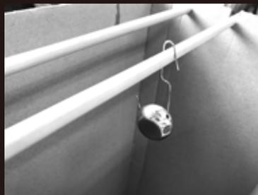
クリップなどで鯛ラバヘッドの穴にクリップを通し、吊り下げられるようにして下さい。また、クリップを通した塗装物を吊るして乾燥させる為の乾燥ボックスを事前に準備して下さい。
