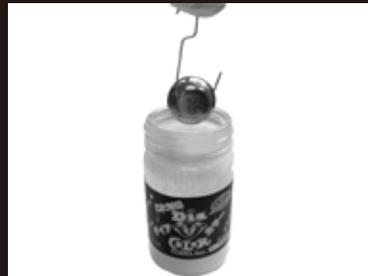
はじめに、「どぶづけ用ダイアカラーベースホワイト」で3～4回程度ドブ漬けで下地塗装を行って下さい。塗装の間隔は塗料が硬化する30分～1時間程度で次の塗装が可能です。
