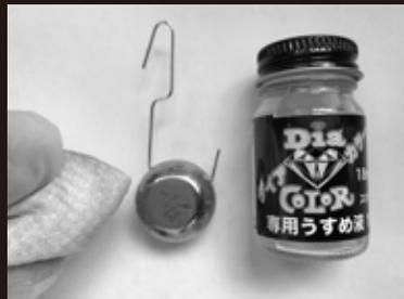
鉛の形状を変える場合などは塗装前に行ってください。塗装面の水分、油分、サビ、汚れ等を『ダイアカラー専用うすめ液』や『EX 塗料共通うすめ液』等を使用し除去します。
