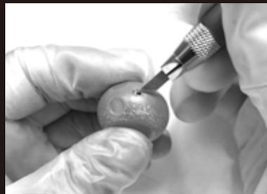
最終の塗装完了後、クリップを外し、塗料でふさがったクリップ部の穴の塗料をカッターやヤスリ等でバリが残らないように除去します。穴にパイプを通す場合は、ドリル等で穴を開けパイプを固定してホロシールなどを貼ったら完成です！
